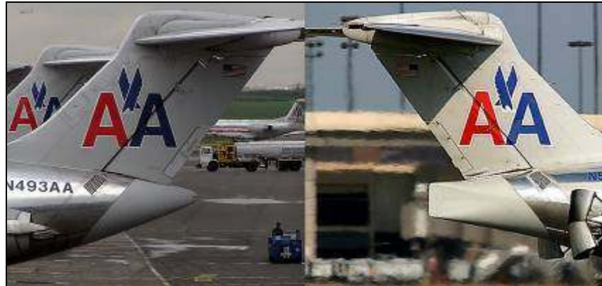
Şekil 5, Solda MD-80 serisi uçakların eski kuyruk konisi (Futterman, 2003), sağda ise American Airlines ve Boeing'in işbirliğiyle ortaya çıkarılmış yeni kuyruk konisi görülüyor (Perkins, 2005).
