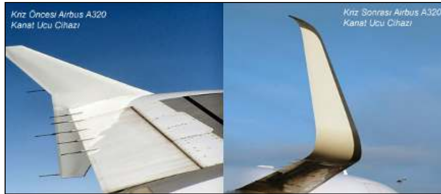
Şekil 4, Airbus A320’lerde kullanılan eski ve yeni tip kanat ucu cihazları (Uyar, 2008b)
